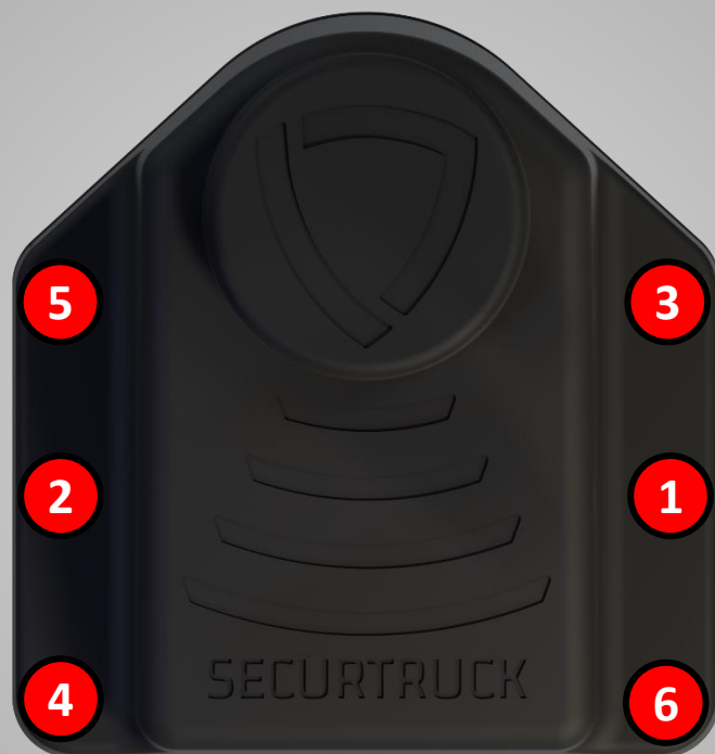
Atornillar los 6 tornillos de cierre en el orden indicado (2Nm max)
